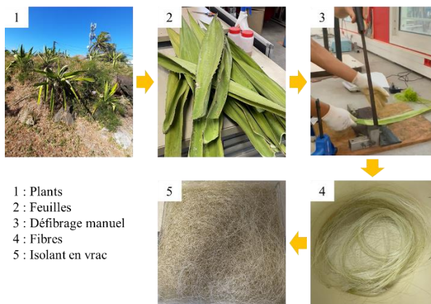
Figure 1 – étapes de la préparation de l'isolant en vrac à base de fibres de choka
