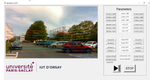
FIGURE 3 – L'application développée par les étudiants pour la mise au point des paramètres extrinsèques Vision RGB-D/LiDAR et la reprojexion de données de la télémétrie sur un flot d'images.
