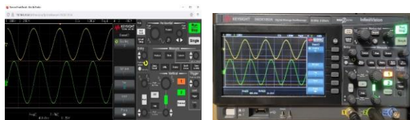
Figure 5 – Face-avant virtuelle (gauche) et réelle (droite) d'un oscilloscope.
