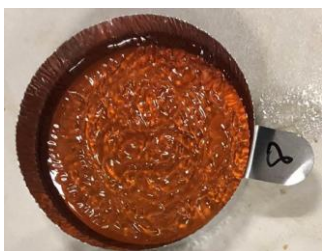
Figure 3 – Photographie d'une résine à base de colophane et huile de lin, avec un catalyseur de siccativité. L'aspect craquelé de la résine apparaît lors du séchage, et trahit un séchage en surface uniquement. A l'intérieur de la résine, le mélange reste d'une viscosité qualitativement semblable.
