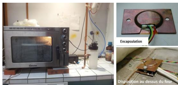
Figure 5 – Mesure de température d'aliments en cours de cuisson dans un four industriel.
